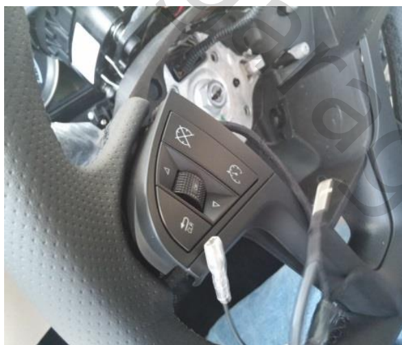
شکل پنج : نصب کلیدهای کروز و کنترل ضبط
