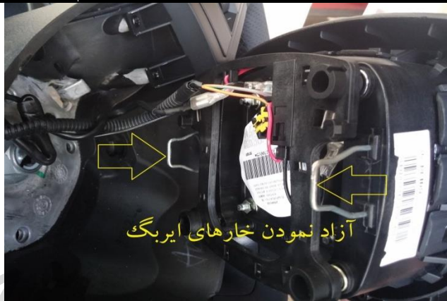
شکل دو : آزاد نمودن خارهای ایربگ
